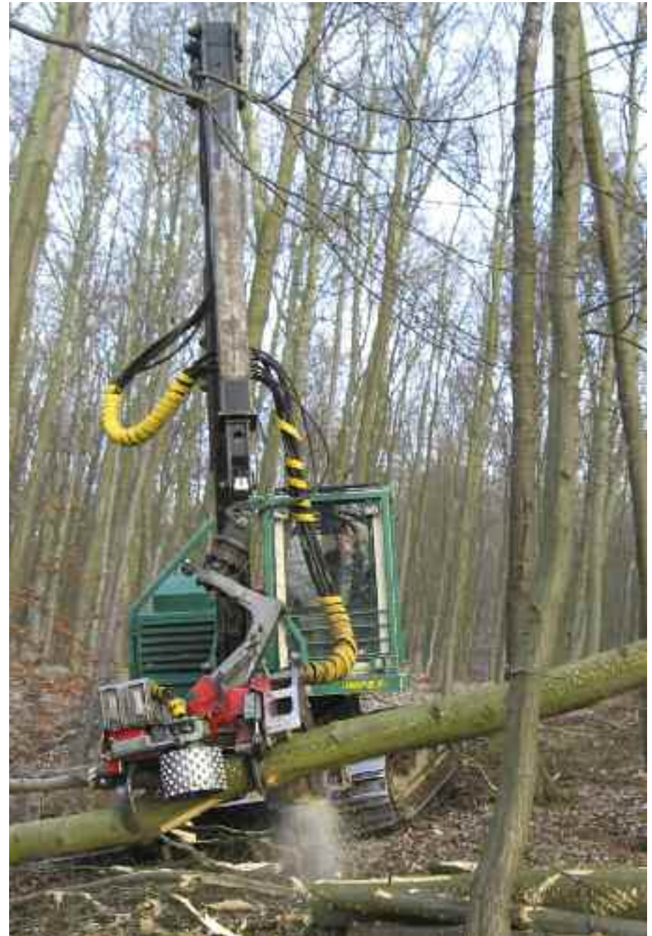
Ein moderner Ketten-Harvester im Winter 2008 im Harler Wald bei der Aufarbeitung von Laubholz.
