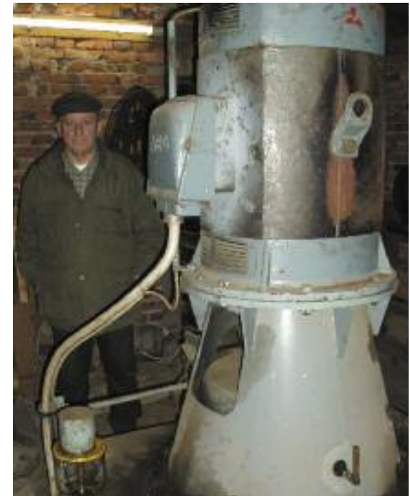
Aber Wasser kann auch anders. Hier treibt das Wasser eine Turbine zur Stromerzeugung an.
